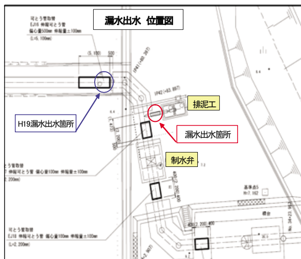
図-1 漏水出水位置 平面図
