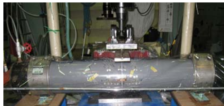
Photo.1 30万回繰返し载荷後の状況
