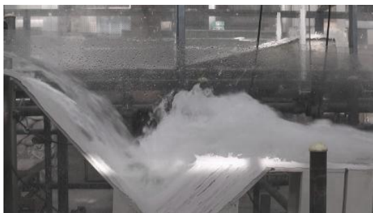
Fig.1 水路勾配 1/20、流量 22.8L/s(落下流)
