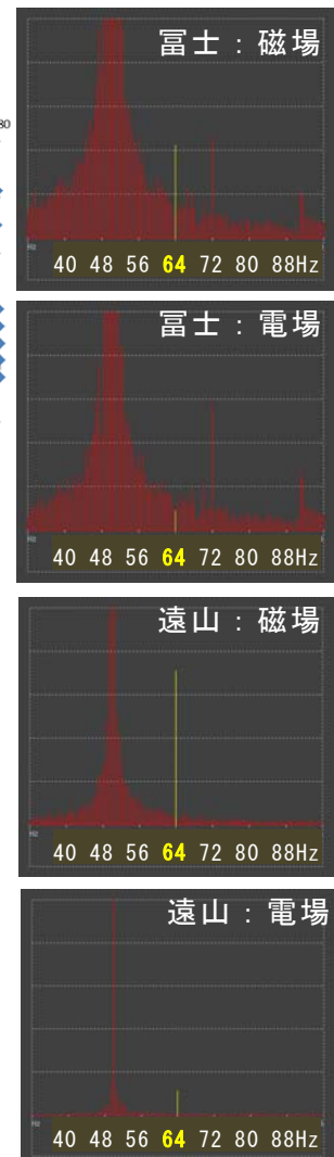
図 3 試作システム波形処理結果 (黄色バー: 64Hz 信号, 赤色バー: ノイズ, 縦軸は 1 目盛り 0.25mV) Waveform processing result of the prototype system
