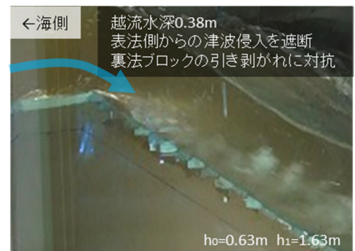
図-8 新形式防潮堤モデルの実験状況 New type coastal dike
