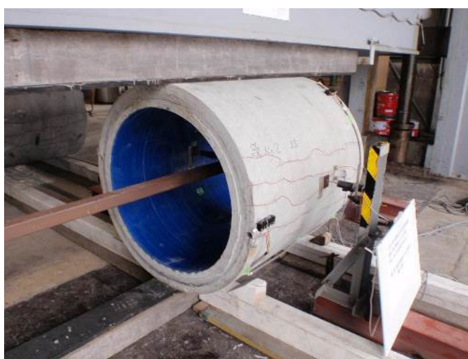
Pic.2 繰り返し載荷後の外圧試験状況 Parallel plate loading test
