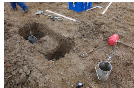
写真1 現場透水試験状況
