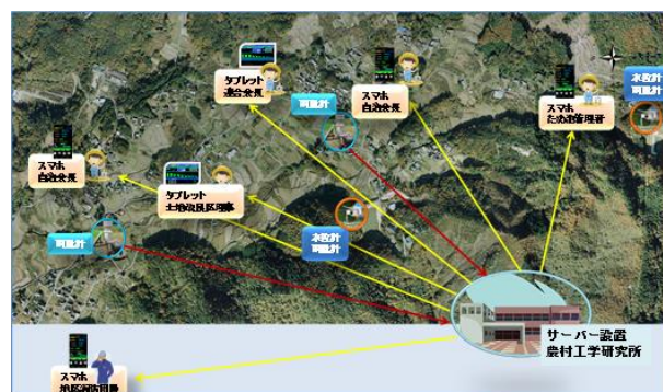
図-2 簡易降雨等観測システムの設置
