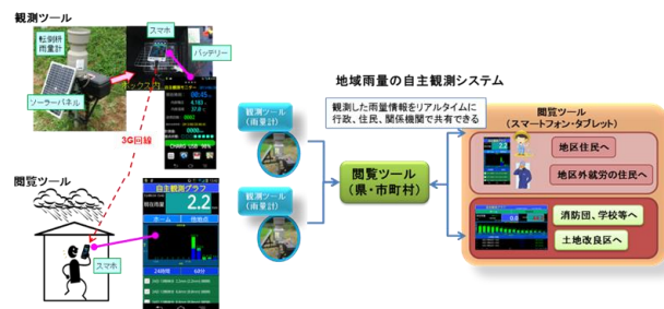
図-1 地域自主簡易降雨等観測システム
