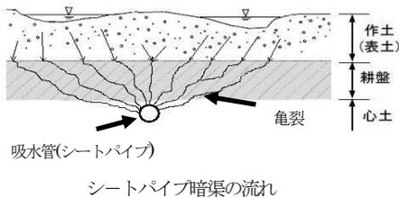
基本的には弾丸暗渠の排水メカニズムと同じである。一般の弾丸暗渠との違いは弾丸孔が 100mm~150mm と若干大きいこと、弾丸孔の中にシートパイプ（給水管）が引込まれており、弾丸孔が潰れないこと、吸水管の始端側に立上り管を有し通気が行われること、本暗渠であり、直接排水路に排水されることなどである。
