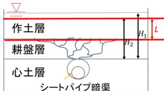
ここで、 $H_1$ および $H_2$ は弾丸孔の上端までとし、耕盤層内には水は亀裂のみを迅速に移動するものとし浸透路長 $L$ は作土層の厚さとした。
