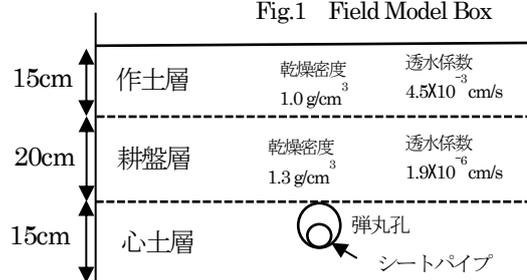
シートパイプの一端はキャップ付排水口とし、反対側は立上り管を立て、通気口とした。
