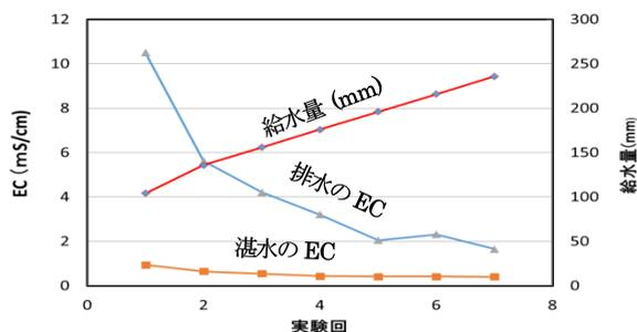
図3 湛水・排水のECの経時変化
