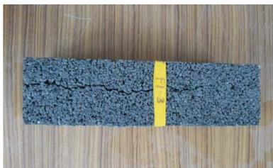
図3 P1 供試体の崩壊状況
