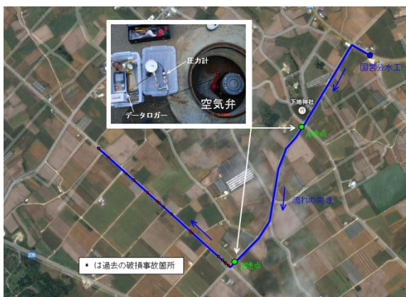
図 1 管内の圧力水頭の計測箇所
