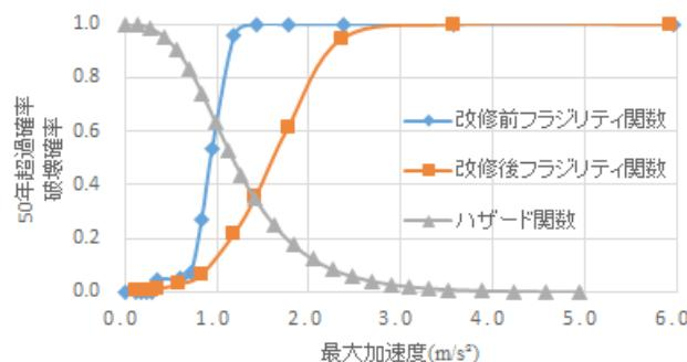
Fig.3 地震ハザードおよびフラジリティ曲線
