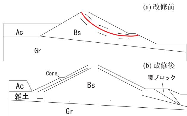
Fig.1 解析対象ため池の断面
