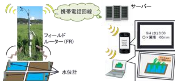
図1 農業水利情報サービス提供システム Irrigation information service system
