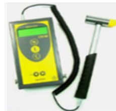
写真-1 テストハンマ 写真-2 Mr 試験
