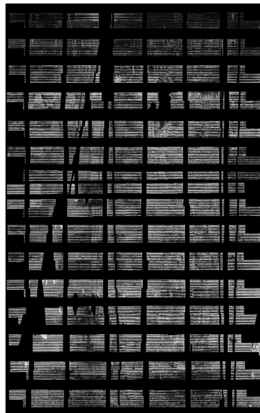
図-3 彩度値による腐食箇所の同定
