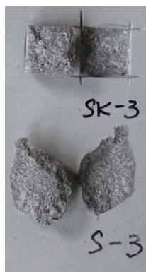
図2 SKとSの破断面の状況
