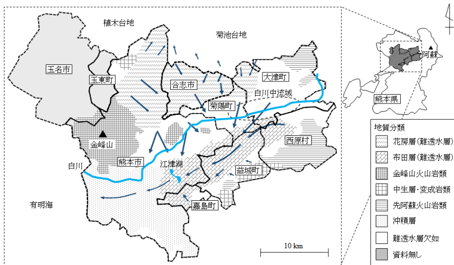
図 1 熊本地域の地質と地下水流動（富家ら（2011）を一部修正）
