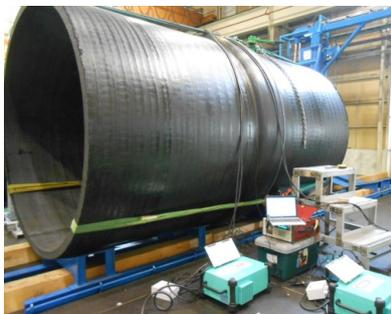
Fig.4 大口径電気融着継手
