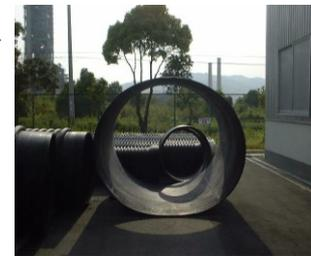
Fig.3 大口径PE管の偏平
