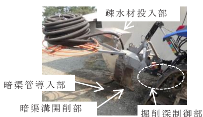
図1 浅層暗渠施工器本体全景
