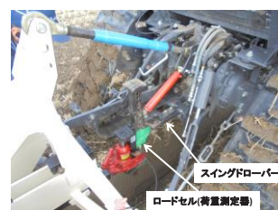
図3 荷重測定状況
