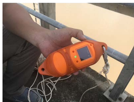
Pic. 1 計測に用いた CTD 計 CTD sensor used for the measurements
