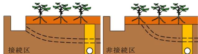
図 1 弾丸暗渠の接続イメージ図
