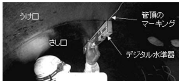
写真-1 デジタル水準器による管体の傾きの測定状況 Photo-1 Measurement situation
