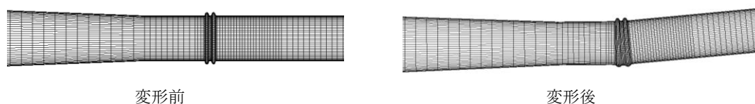
図 4 大変位吸収鋼管の変形
