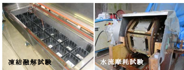
Fig.2 凍結融解試験, 水流摩耗試験 Freeze-thaw test, Water jet abrasion test
