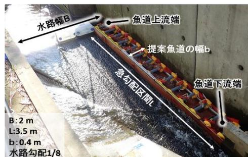
**Fig. 2** 実験現場への提案魚道の設置状況<sup>2)</sup>
