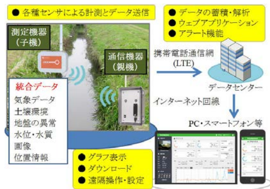
Fig.2 統合型 IoT プラットフォームの概略。 Schematic diagram of integrated IoT platform.
