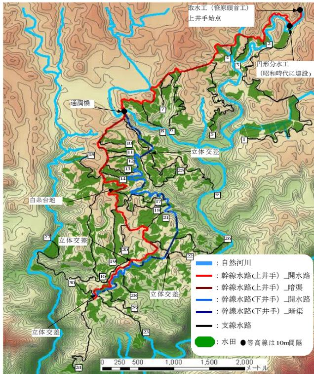
図1 通潤用水水利システムの概要図
