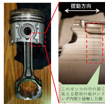
(a) 試験後ピストン A piston after the test
