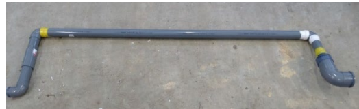
図3 実験で用いたサイホン Fig.3 The siphon used in the experiment
