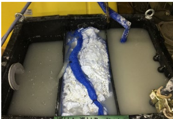
写真-2 土粒子除去性能試験の様子 State of examination
