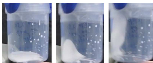
図1 静止状態で液状である懸濁液(左)が振動下で壁面に沿って登る様子(中, 右) [1].
