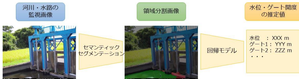
図-1 水位・ゲート開度推定モデルの構成 System structure of sluice gate opening detection system
