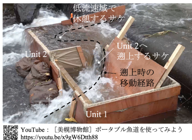
Fig. 3 可搬魚道を利用したサケの遡上 Upstream migration of salmon using the portable fishway
