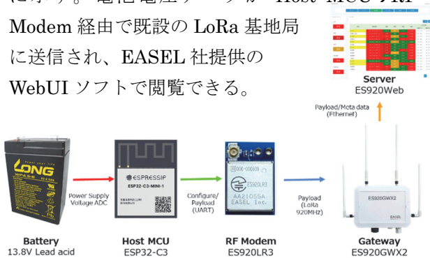
図3 中継器の電池電圧モニタリングデータの流れ
