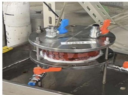
写真-1 透水試験状況
