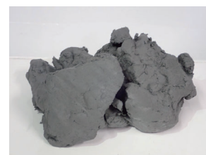
写真1 砕石脱水ケーキ Crushed stone dehydrated cake
