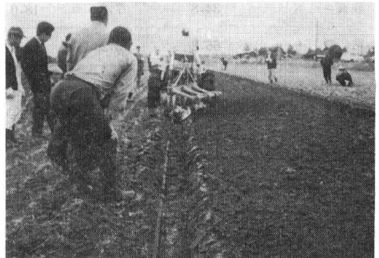
図-5 強制ロータリ・ハロー付三連プラウ
