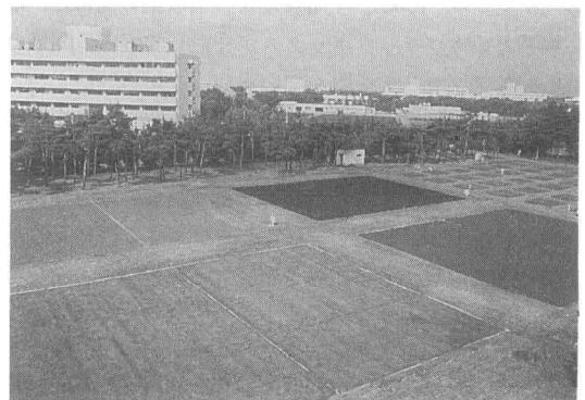
写真-1 4種類の土壌が充填された圃場
