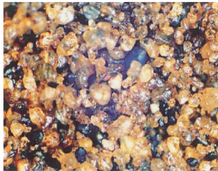
写真-2 C重油による人工汚染珪砂 濃度1wt%
