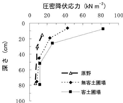
図-4 未墾地と農地での土層の圧密降伏応力
