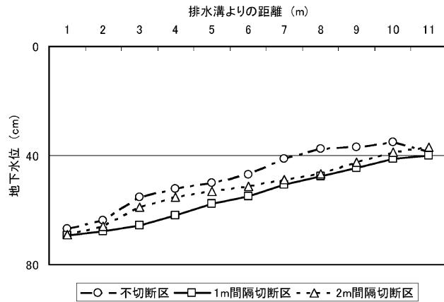
図-1 切断暗渠の地下水位に及ぼす効果
