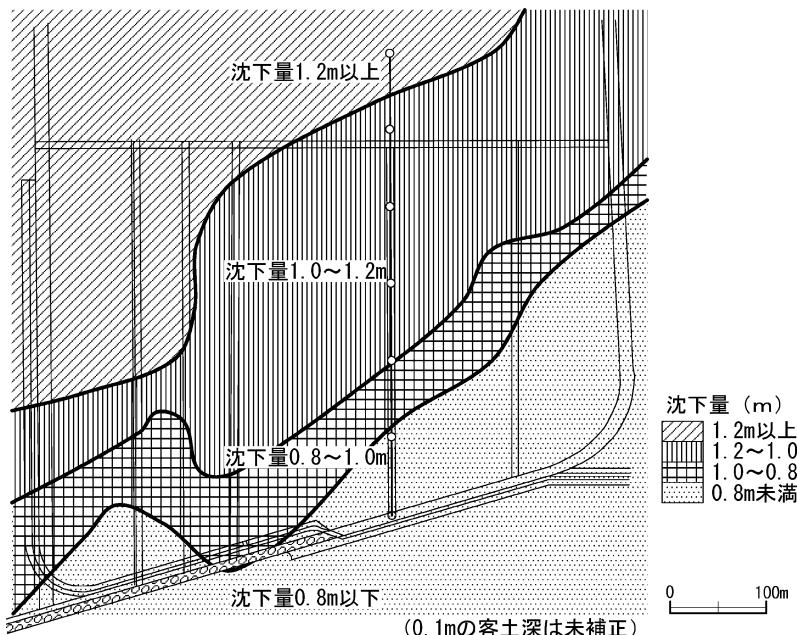
図-5 草地造成後の沈下量の分布
