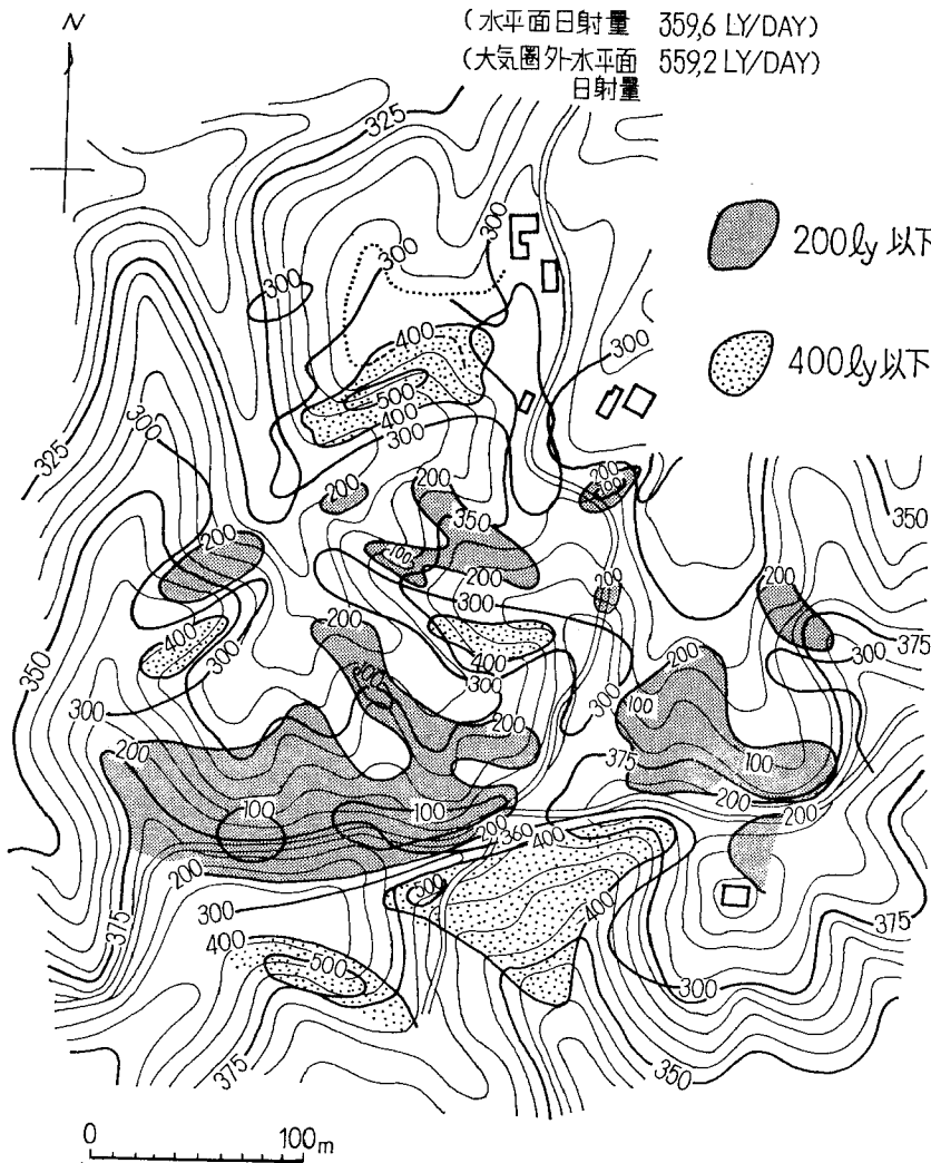
図-9 日射量分布の計算結果の一例 (1972. 10. 27)
