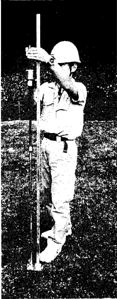
土壌貫入計作業風景
