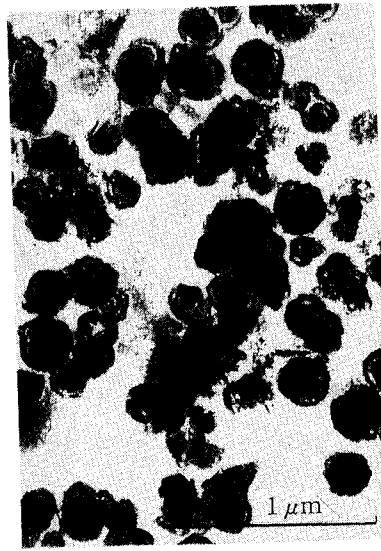
図-4 球状ハロイサイトの電顕写真(庄子貞雄氏) (文献(8)p. 177より引用) Fig. 4 Electron micrography of Halloysite. (Cited from Yamane et al. literature 8) p. 177)
