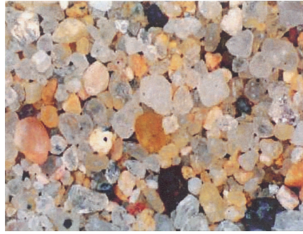
写真-1 珪砂 拡大写真 15倍 (以下同様)
