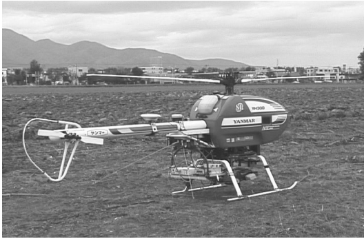
写真-1 産業用無人ヘリコプタ Photo 1 Unmanned helicopter.
