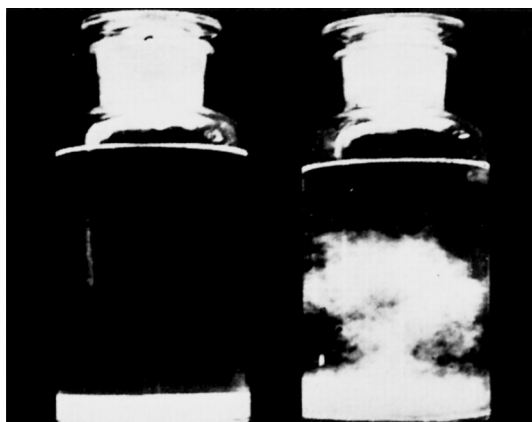
図-1 上村試料からアルカリ性で分散した画分 (左) と酸性で分散した画分 (右) の 1\text{ mol L}^{-1} 塩化ナトリウム中での凝集の様子。日本土壤肥料学会の許可を得て転載。
