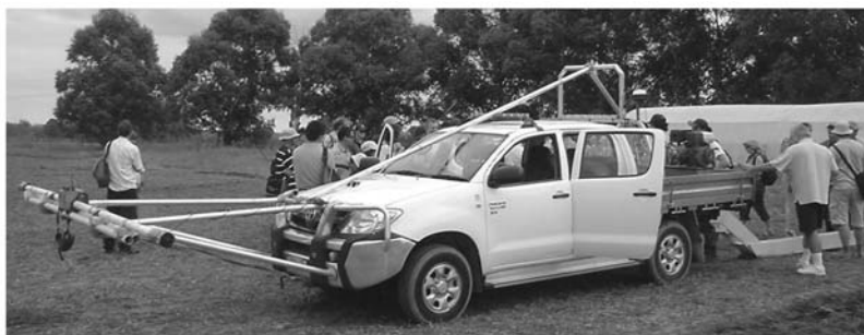
写真 農場の土層構造を測定しながら地図を作成するためのDSM(Digital Soil Mapping)車
