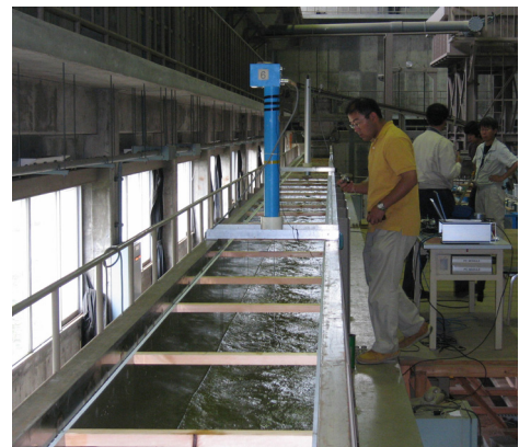
図2 粗度係数の計測風景
