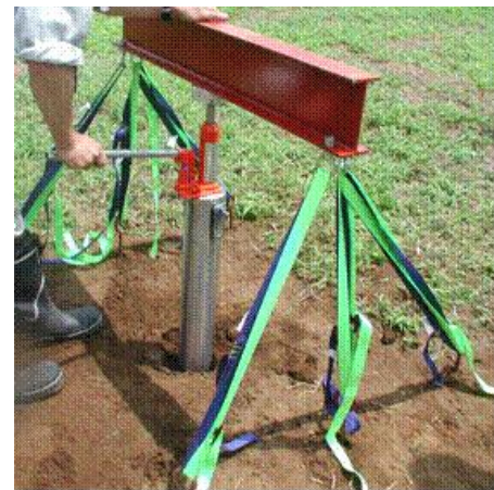
図2 円筒カラムの圧入状況
