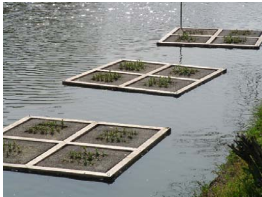
写真-2 浮島型リン吸着コンクリート Floatable phosphorous adsorption concrete
